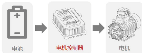
▲ 电机控制器工作原理图
