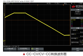
▲ CC-CV/CV-CC转换波形图
