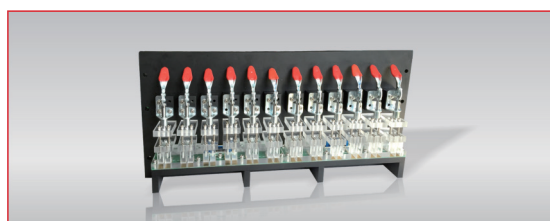
▲ 测试治具实物图
